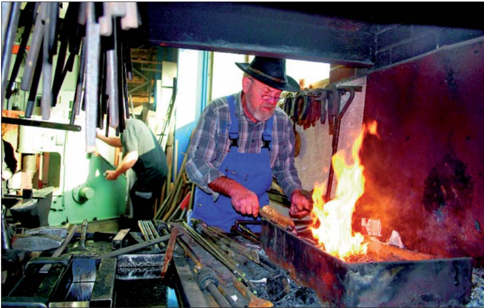
Wie in alten Zeiten: Gottlieb Schittenhelm an der Esse, wo das Metall zum Glühen gebracht wird, bevor es am Amboss mit gezielten Hammerschlägen geformt wird. Rings um die Esse hängen zig Zangen, die selbst gefertigt.
