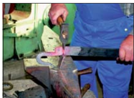
Ein Haken entsteht
